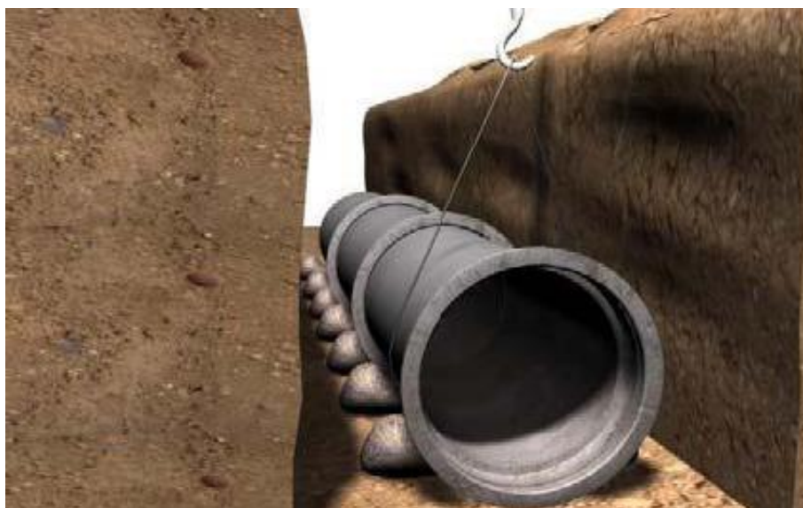
Figura 15 - Alinhamentos dos tubos com apoio de calços
